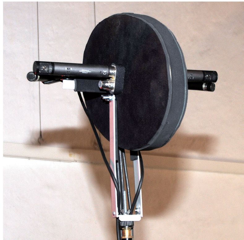
Die Jecklin-Scheibe, wie sie im April 2011 im Klangschloss Greifensee zum Einsatz kam.
